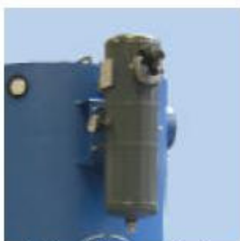
Paineilmasäiliö ja automatiikka. Puhdistuksen aika säädettävissä.
